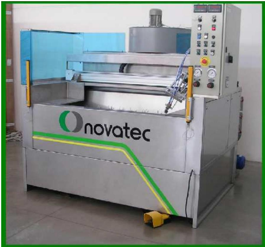
**CABINA:** Interamente realizzata in acciaio inossidabile AISI 304m, è provvista di doppio velo d'acqua, vasca di raccolta, separatore a setacci multipli e filtro d'aria.
