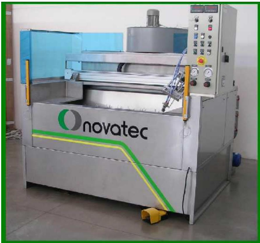
**CABINE:** Entièrement réalisé en acier inoxydable AISI 304, équipée de voile d'eau, bac de rétention et filtre pour l'air.
